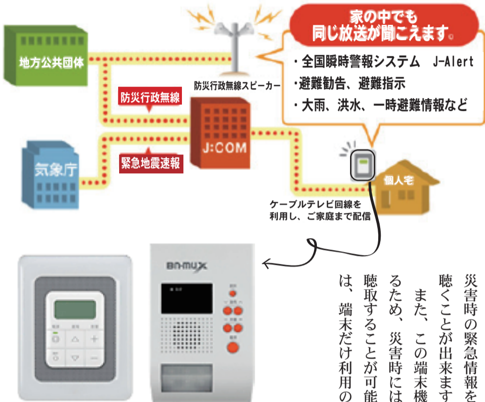
防災情報サービス受信端末機 FMラジオが聴けます
