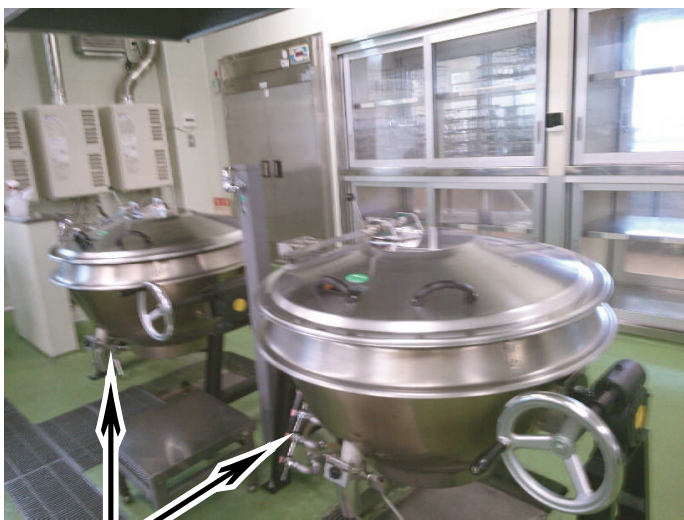
夏休み中に新しく入れ替えした2台の回転釜 (9月19日 給食調理場を見学し撮影)
